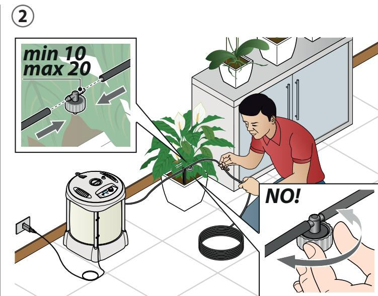
**IT INSTALLAZIONE.** Usare i raccordi a T per realizzare le deviazioni. Attenzione: ultimato l'impianto inserire il tappo di fine linea. Posizionare il seletore su OFF e riempire il serbatoio con acqua pulita (al massimo 30 litri), priva di sostanze chimiche o fertilizzanti. Ricordarsi di chiudere il coperchio con il tappo.
